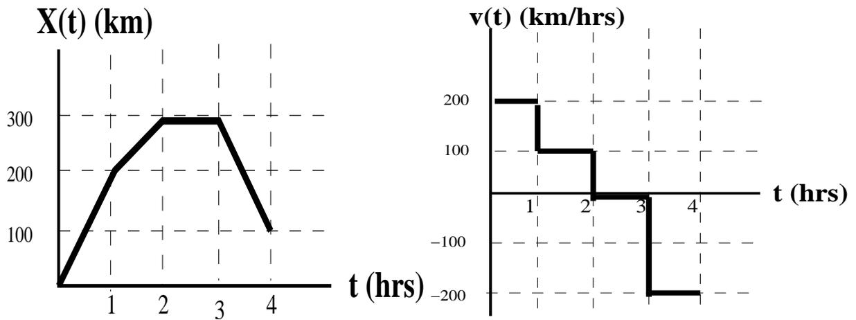
Figura 1: (a) Posición en el tiempo. (b) Velocidad en el tiempo
