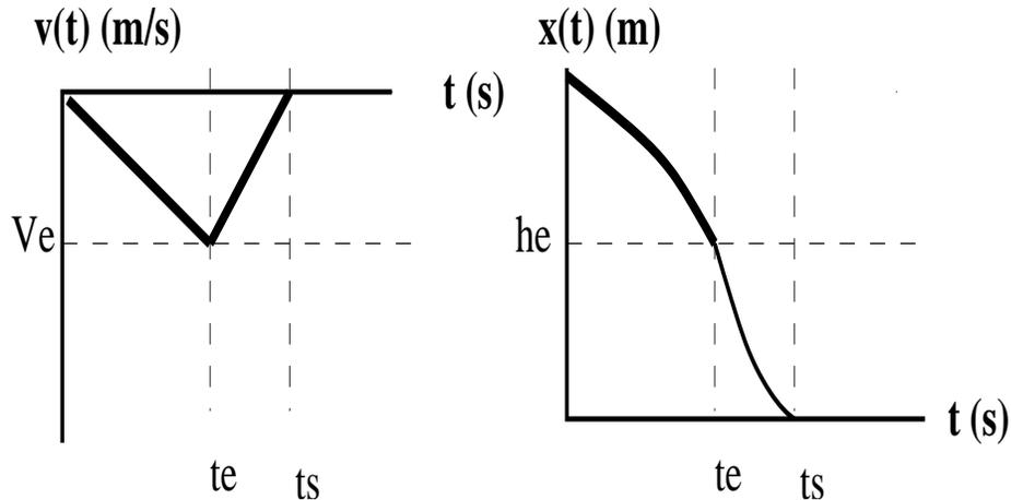
Figura 16: (a) velocidad y (b) posición del piano.
