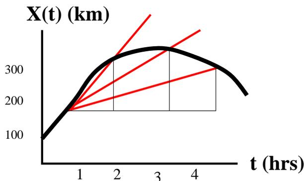
Figura 2: (a) Posición en el tiempo con líneas que describen la velocidad promedio para diferentes valores de  $\Delta t$ .
