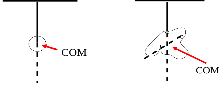
Figura 7: (a) Centro de masa del péndulo (b) Centro de masa objeto complicado
