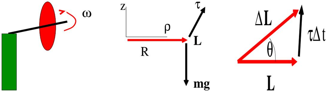
Figura 5: (a) Giróscopo (b) Diagrama de fuerzas. (c) Cambio de momento angular
