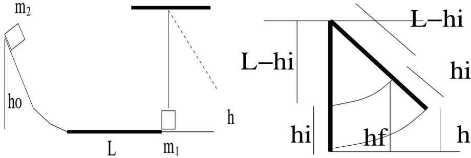
Figura 4: (a) Colisión con el péndulo. (b) Diagrama para calcular  $h$
