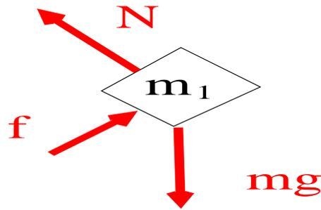
Figura 2: (a) Diagrama de Fuerzas para  $m_1$  arriba. (b) Diagrama de Fuerzas para  $m_1$  en contacto con el resorte.
