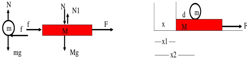
Figura 7: (a) Diagrama de fuerzas. (b) variables auxiliares.
