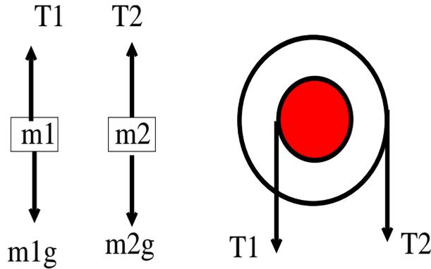
Figura 5: Diagrama de Fuerzas para la máquina de Atwood.
