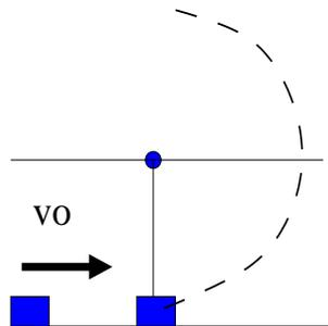
Figura 1: Colisión masa con péndulo con masa
