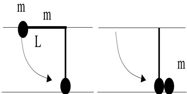
Figura 1: (a) Condición inicial del péndulo. (b) Colisión con la masa puntual en el suelo.
